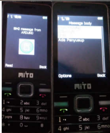
Gambar 4.8 Tampilan Pintu Terbuka dan Notifikasi SMS
