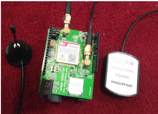
Gambar 4.2 Pemasangan Antena GSM dan GPS
